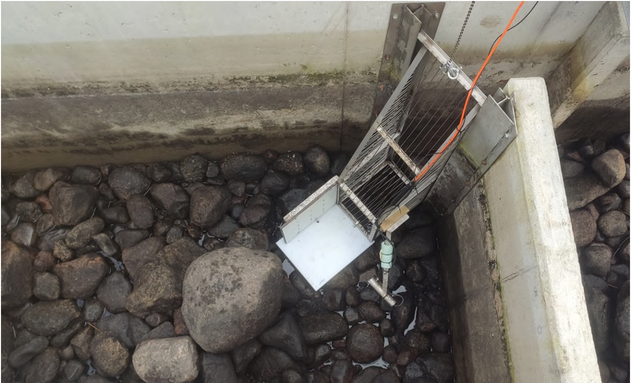
Kuva 3. Leuhun kalatien yläosan seurantapaikka (ohjauskehikko, valo, kamera ja valkolevy).
